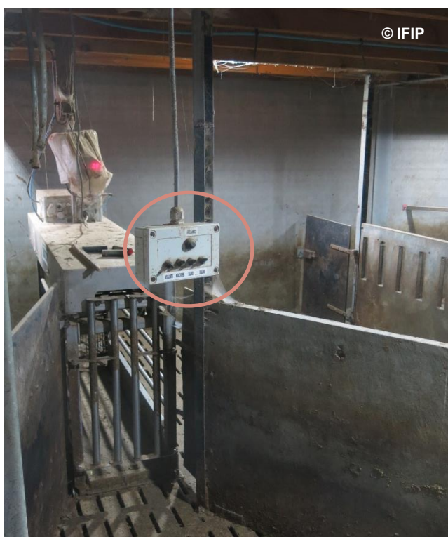
Selon son poids, l'animal ira, à droite, sur l'aire de stockage ou, à gauche, pour retourner dans sa case. L'éleveur pilote cela à distance grâce au boîtier de commande.
