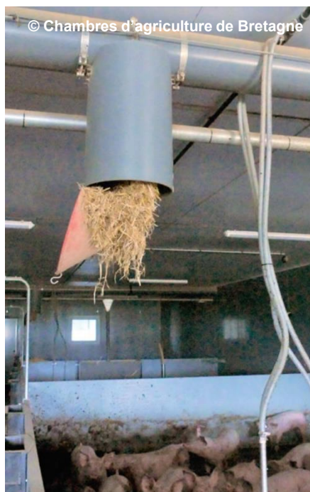
Réseau de chaîne à pastilles équipé de doseurs et surplombant les zones à pailler (caillebotis partiel ou litière accumulée)
