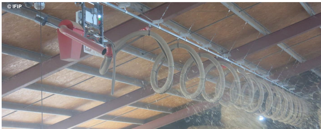
Canon à paille se déplaçant, au-dessus des cases, sur un rail avec un mouvement de balancier
